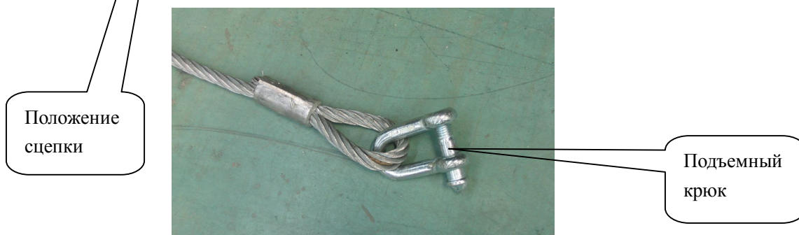
Рис 2-2. Способ подъема фермы
