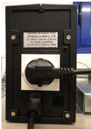
Рисунок 6.3: Соединение ИБП
