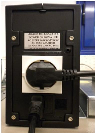
Рисунок 6.13: ИБП соединение
